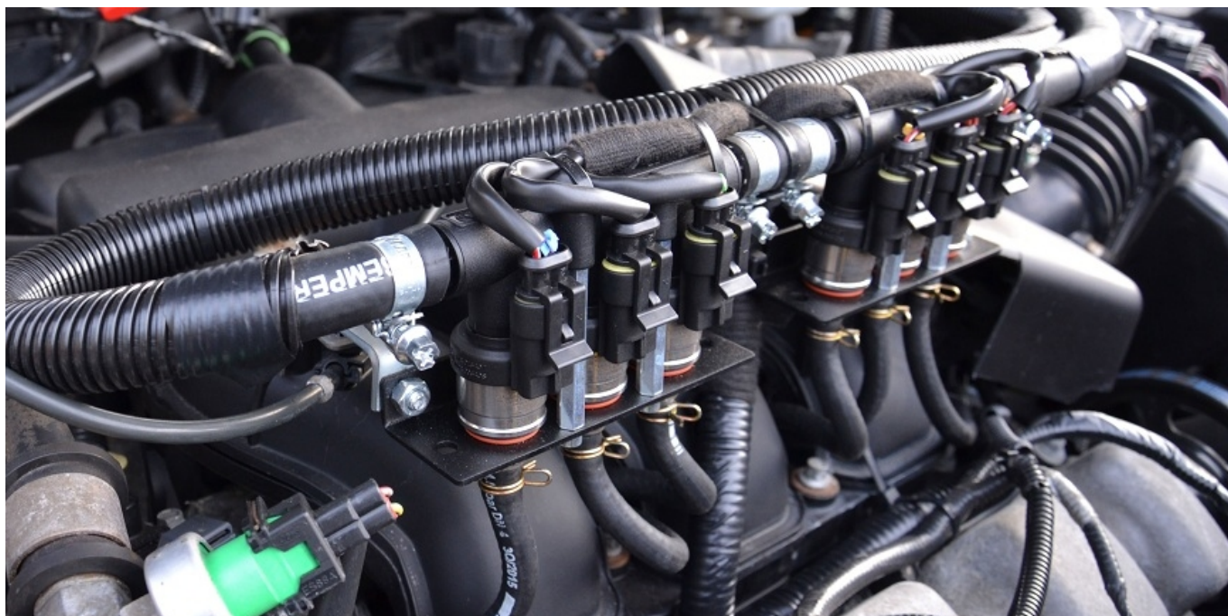
Montaż wtryskiwaczy, Fot. ALEX
