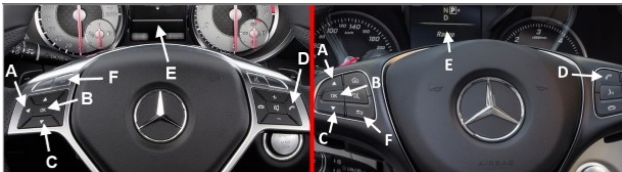
Ilustracja 1. Oznaczenie przycisków kierownicy wielofunkcyjnej.
