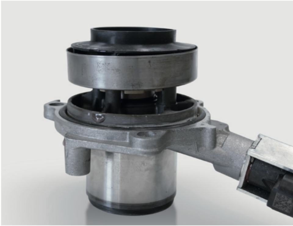
Regulowana pompa chłodziwa z zaciętą przesłoną (brak cyrkulacji)
