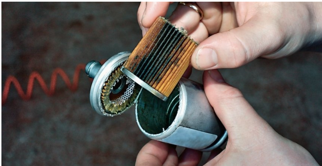
Wnętrze filtra LPG po przebiegu 20 tys. km
