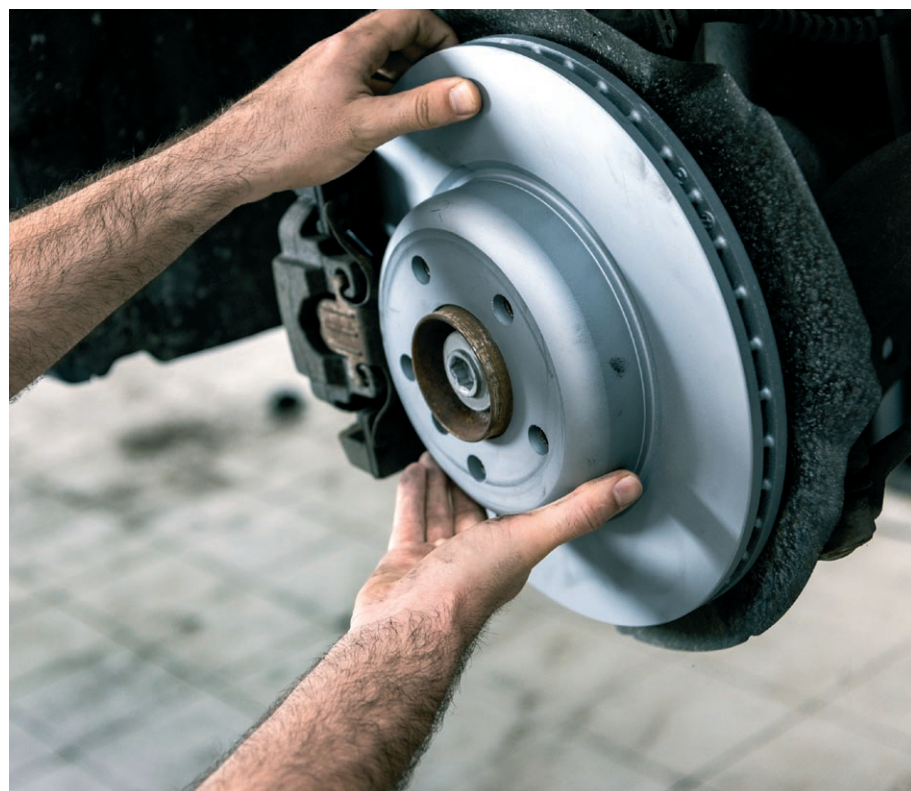
Drganie hamulca jest zazwyczaj odczuwalne jako wstrząs boczny na kierownicy, pulsacja na pedalach lub nawet wibracje w podłodze podczas hamowania
