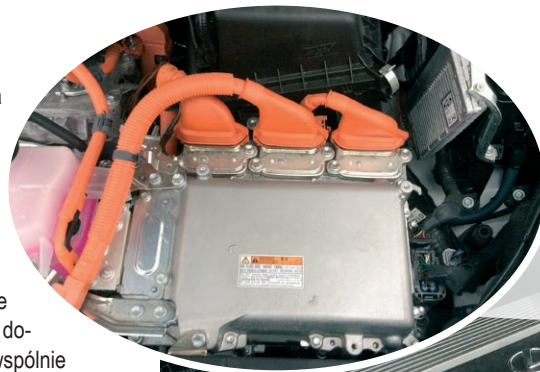
Komora silnika samochodu marki Lexus z widocznym modulem mocy i przewodami instalacji wysokowoltowej (kolor pomarańczowy) napędu hybrydowego
