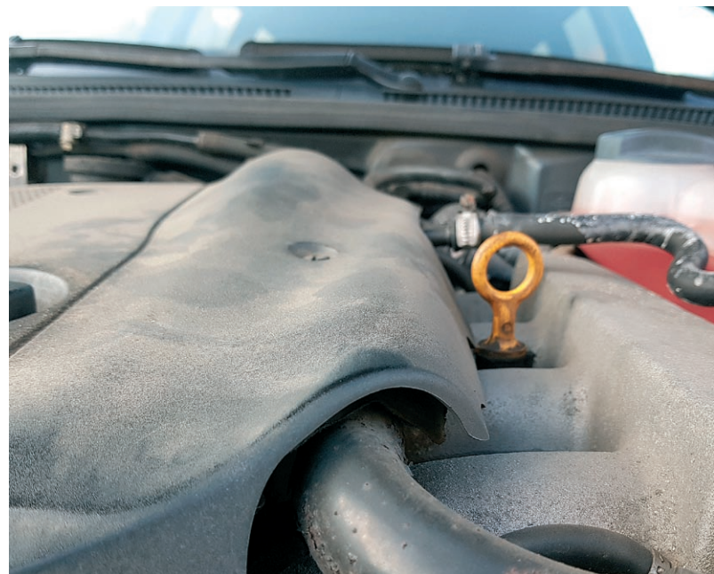
Zabrudzona, zaolejona komora silnikowa degraduje filtr kabinowy
