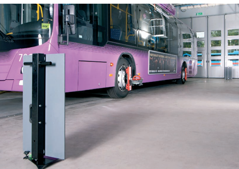
Rys. 14. Ustawienie elementów przyrządu i-track firmy Josam podczas pomiaru geometrii podwozia autobusu (źródło: Josam)
