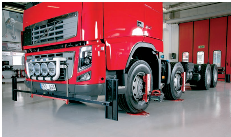
Rys. 13. Ustawienie elementów przyrządu Truckaligner 180 firmy Josam podczas pomiaru geometrii podwozia samochodu ciężarowego (źródło: Josam)
