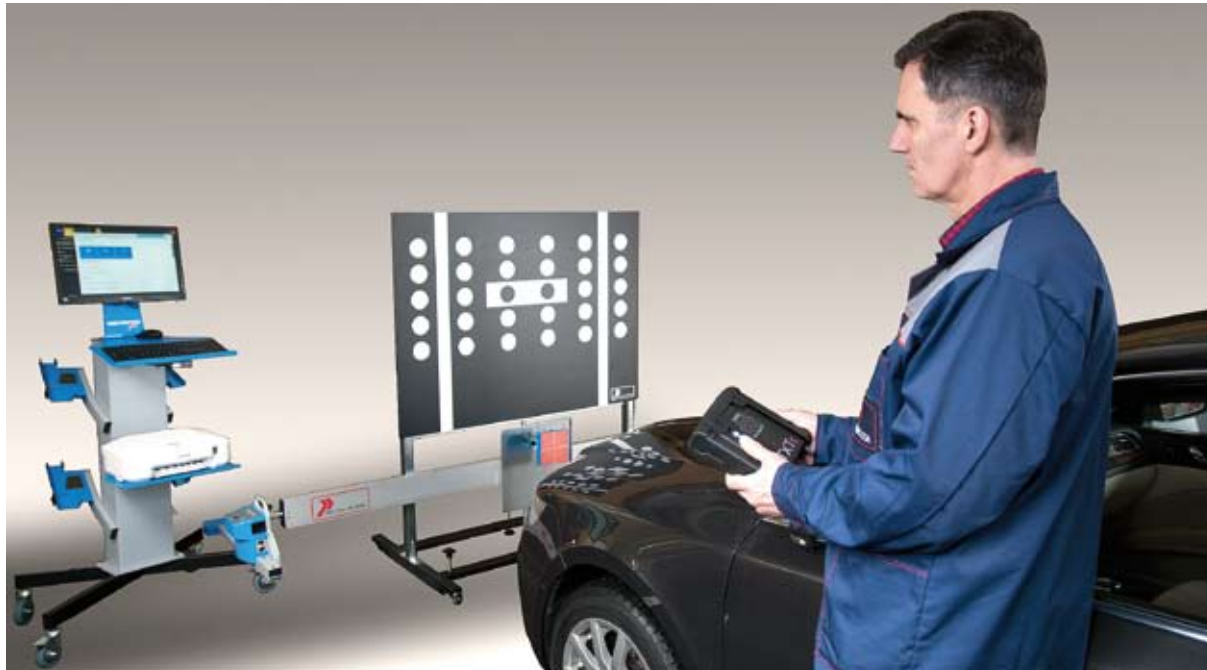
W poprzednim wydaniu pisaliśmy o opracowanym przez Precyzję-Technik systemie CalAdas, umożliwiającym warsztatom kalibrację systemów ADAS w najróżniejszych modelach pojazdów
