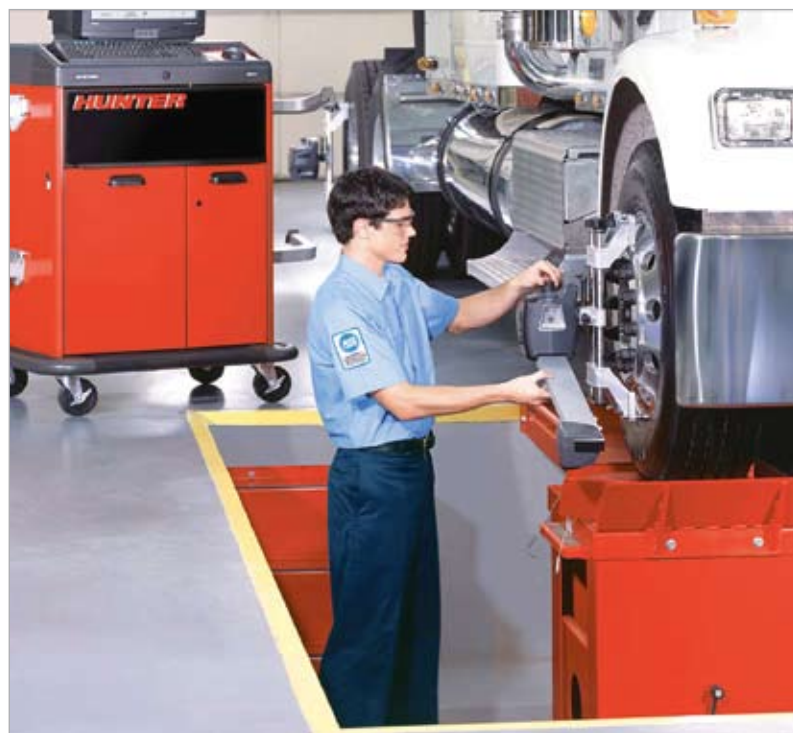
Rys. 2. Przyrząd komputerowy firmy Hunter z głowicami DSP 506T do kontroli ustawienia kół i osi jezdnych w pojazdach o dmc ponad 3,5 t (źródło: Hunter)
