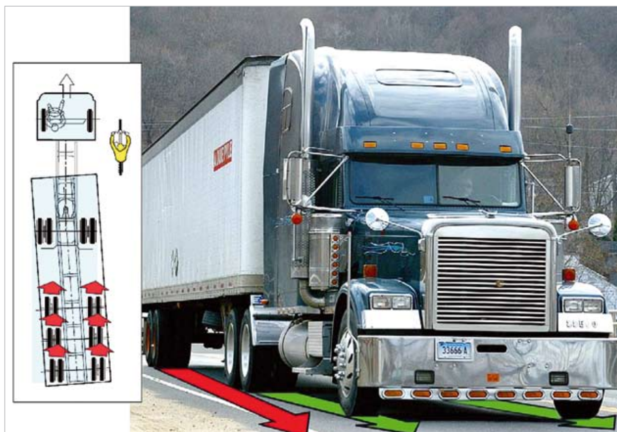
Rys. 1. Wpływ nieprawidłowej geometrii podwozia (ustawienia osi) na prowadzenie zespołu pojazdów i bezpieczeństwo jazdy (źródło: Josam)
