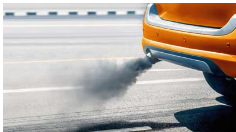
Czarny dym jest spowodowany brakiem równowagi w mieszance paliwowo-powietrznej
