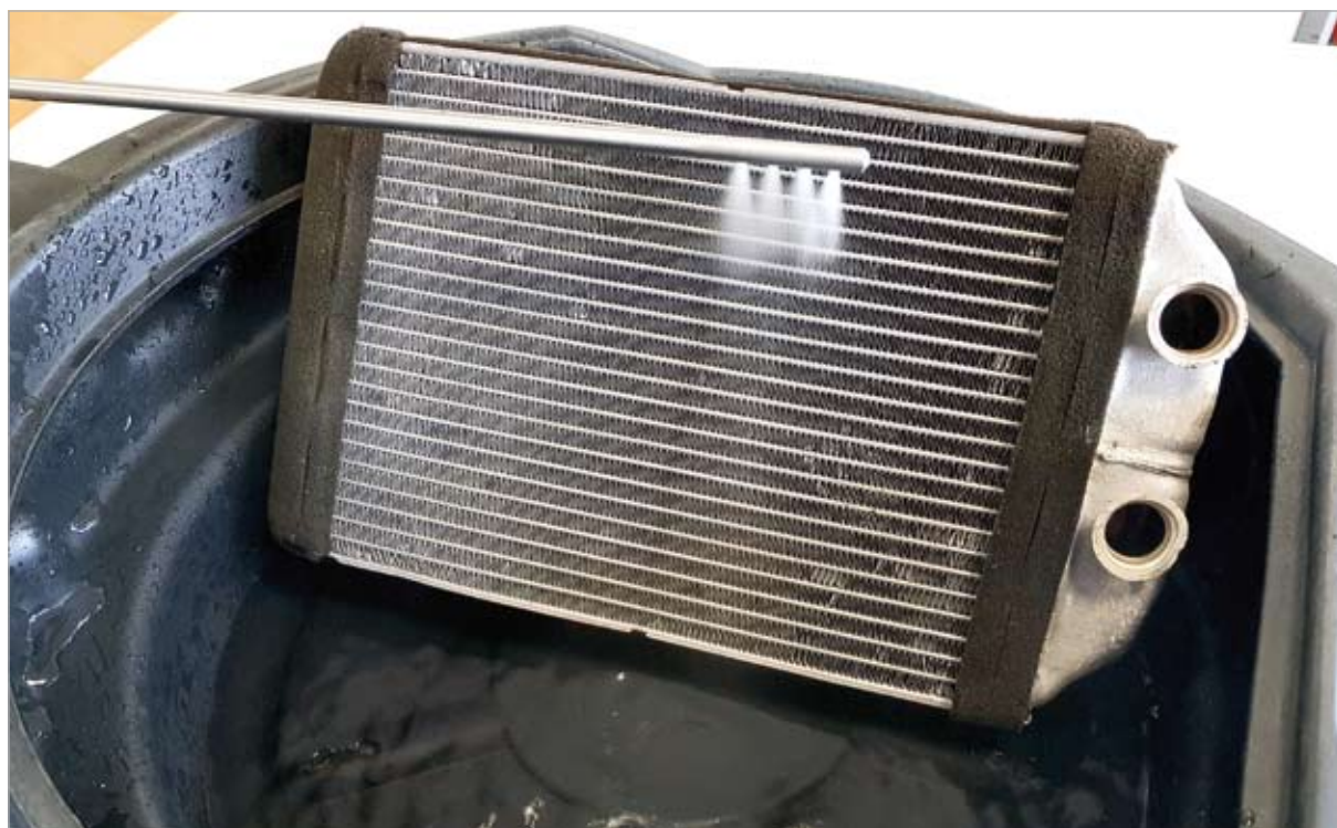
Czyszczenie parownika przy użyciu pistoletu i sondy
