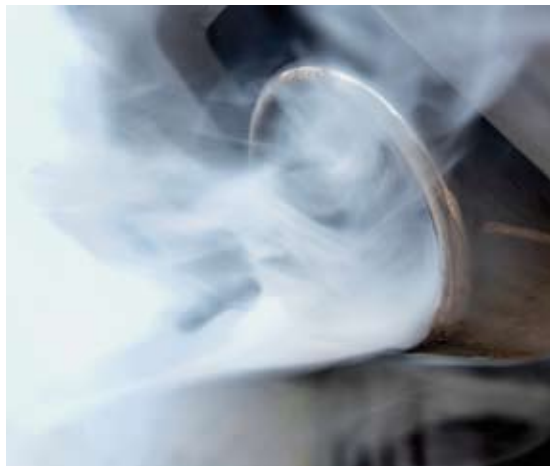
Biały dym pojawia się zwykle, gdy w komorze nie ma wystarczającej ilości ciepła, aby spalić paliwo
