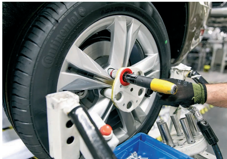
Przymiar do dokręcania kół na liniach montażowych powstał w technologii druku trójwymiarowego
