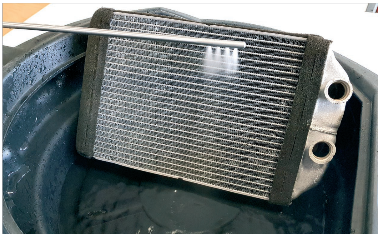
Czyszczenie parownika przy użyciu pistoletu i sondy
