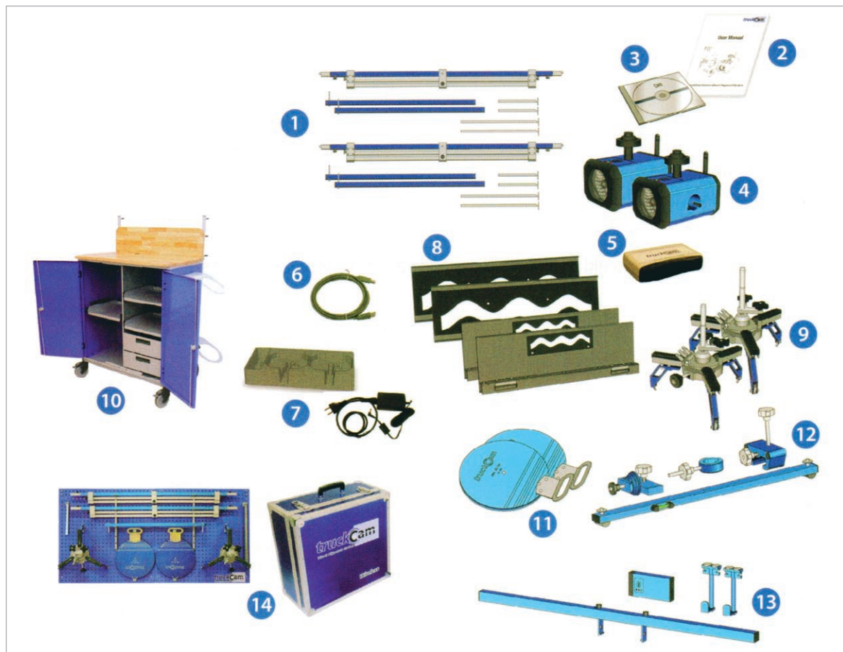
Rys. 3. System TruckCam do pomiaru ustawienia kół i osi jezdnych w pojazdach użytkowych (źródło: Italcon): 1 – samocentrujące uchwyty mocowania ekranów, 2 – instrukcja obsługi, 3 – oprogramowanie, 4 – zespoły pomiarowe (kamery), 5 – serwer komunikacyjny, 6 – kabel USB, 7 – gniazdo ładowania kamer z zasilaczem, 8 – ekrany, 9 – zaciski mocujące, 10 – wózek, 11 – obrótnice, 12 – zestaw adapterów, 13 – zespół inklinometru, 14 – stanowisko odkładcze i walizka
