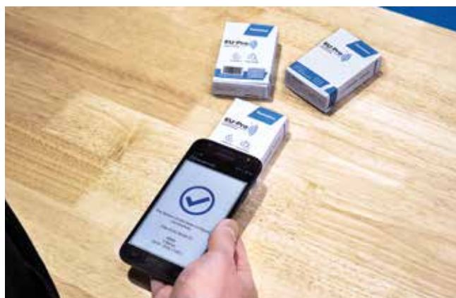
Konfigurowanie czujnika Hybrid NFC z wykorzystaniem aplikacji na telefon z systemem Android
