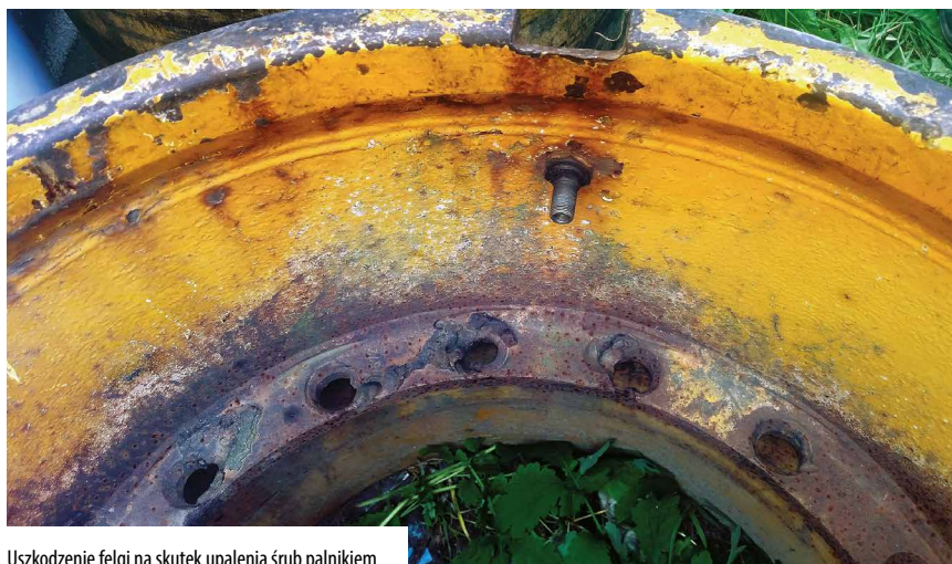
Uszkodzenie felgi na skutek upalenia śrub palnikiem
