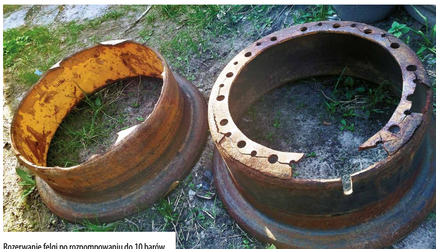
Rozzerwanie felgi po rozpompowaniu do 10 barów
