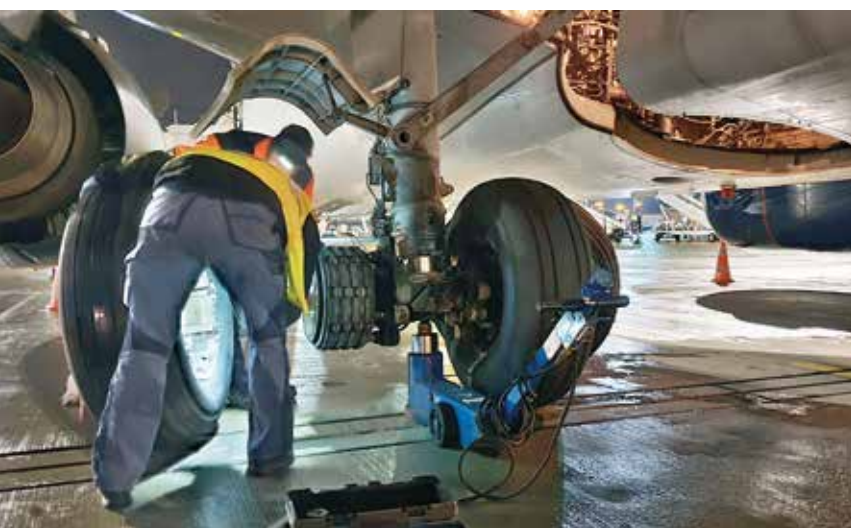
Jednym z wymagań stawianych producentom ogumienia jest zapewnienie małych oporów toczenia kół, co ma znaczenie przy rozbiegu statku powietrznego. Mowa oczywiście o fazie startu samolotu, liczonej od rozpoczęcia jego ruchu postępowego do utraty kontaktu podwozia z podłożem. Koła (i bieżniki opon) są elementami bardzo obciążonymi: w czasie jednej sekundy samolot przyspiesza od zera do prędkości 250 km/h i większej. Zużyte czy zniszczone opony trzeba wymienić w ekspresowym tempie
