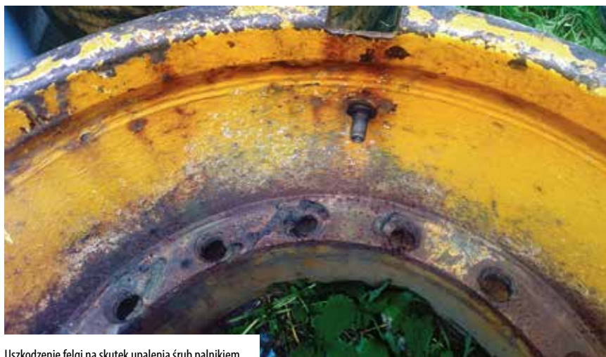
Uszkodzenie felgi na skutek upalenia śrub palnikiem
