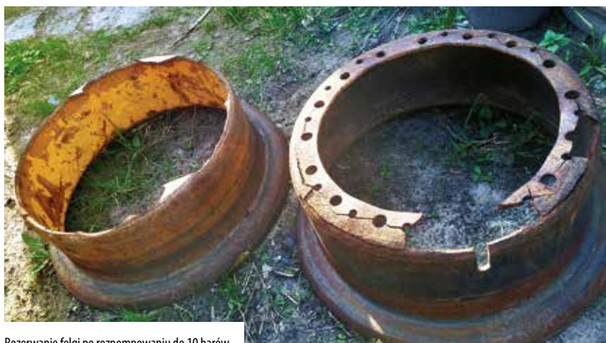
Rozzerwanie felgi po rozpompowaniu do 10 barów
