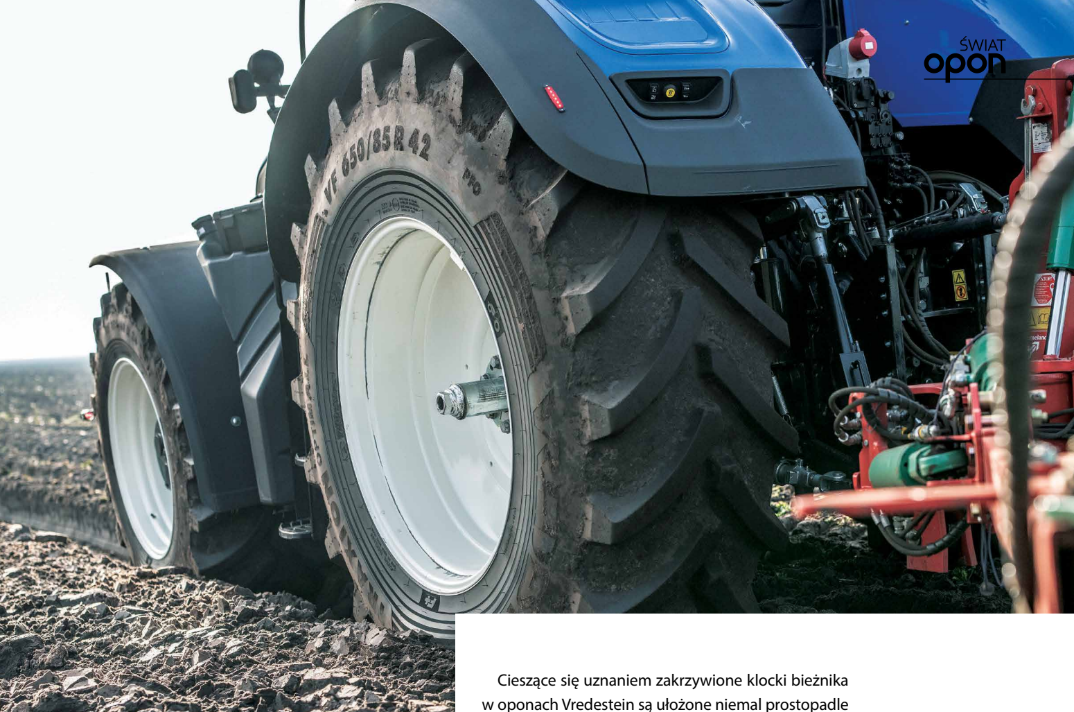
Opona Vredestein Traxion Optimall VF650/85R42 idealnie wpasowuje się bruzdę w ziemi, dzięki czemu doskonale nadaje się do orki
