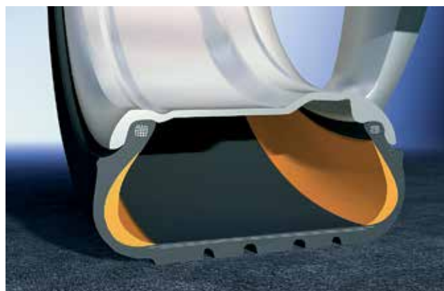
Ogumienie wyposażone w technologię SSR jest w stanie utrzymać ciężar pojazdu, gdy w oponie nie ma już powietrza
