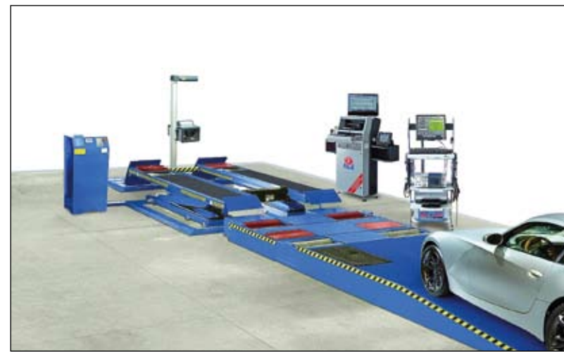
Rys. 4. Stanowisko kontrolne podstawowej stacji kontroli pojazdów z rampą najazdową i podnośnikiem nożycowym (źródło: Maha)
