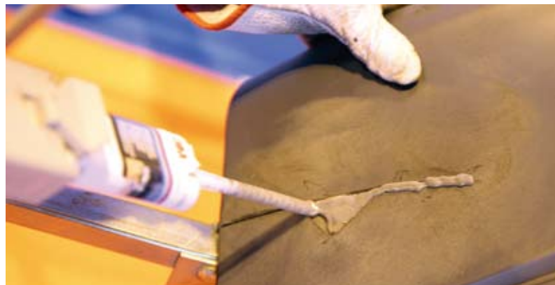
Kadr z odbudowy (sklejania) zderzaka z tworzyw sztucznych 2-składnikowym środkiem do napraw – superszybkim klejem 3M 55045
