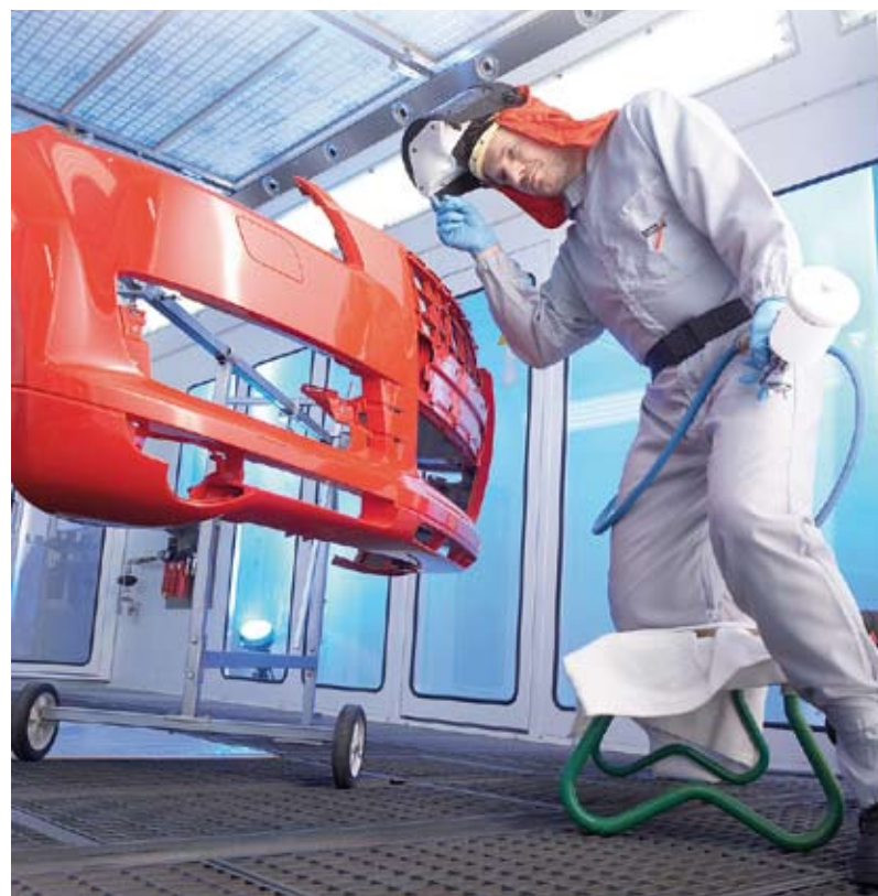
Przed przystąpieniem do lakierowania każdy lakiernik powinien zapoznać się z kilkoma podstawowymi zasadami i najpierw dokonać oceny części z tworzywa. Jak jest składowane? To stara czy nowa część? Polakierowana, zagruntowana czy surowa?
