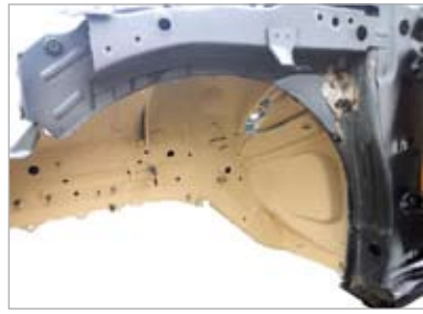
Rys. 7. Uszczelnianie połączeń nadkola za pomocą masy natryskowej STP (fot. NOVOL)
