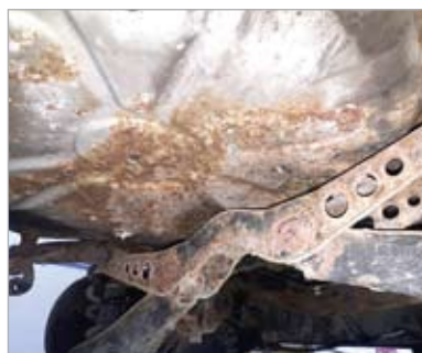
Rys. 1. Zardzewiałe podwozie po kilku latach eksploatacji (fot. Iron Garage Jeleśnia)
