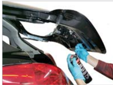
Rys. 8. Zabezpieczenie przestrzeni zamkniętej klapy tylnej przy użyciu wosku Cavity Wax – środek do konserwacji profili zamkniętych (fot. NOVOL)
