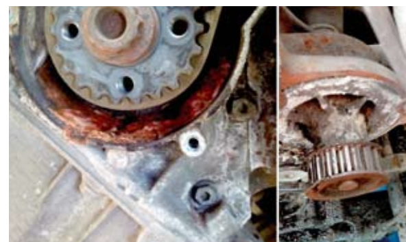
Fot. 4. Niestosowanie się do zaleceń producenta co do wymiany kompletnego rozrządu może spowodować poważne awarie silnika
