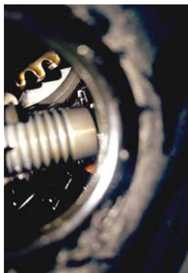
Fot. 1. Otwór inspekcyjny pozwala skontrolować położenie hydraulicznego napinacza łańcucha rozrządu w silniku 2.0 TFSI samochodu marki Audi A6
