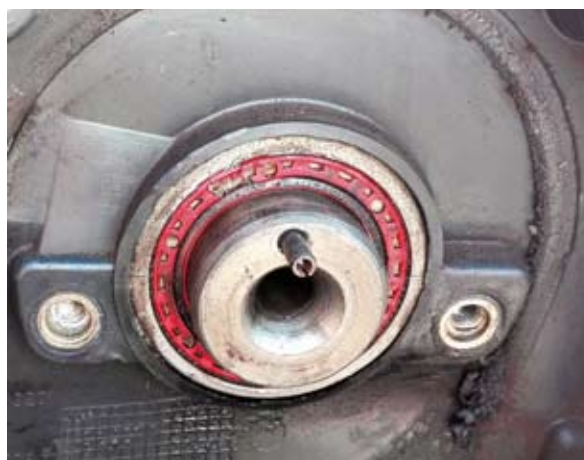
Fot. 2. Uszkodzenie osłony paska rozrządu spowodowane jej termicznym odkształceniem doprowadzającym do tarcia krawędzi koła zębatego napędu wałka rozrządu o jej powierzchnię
