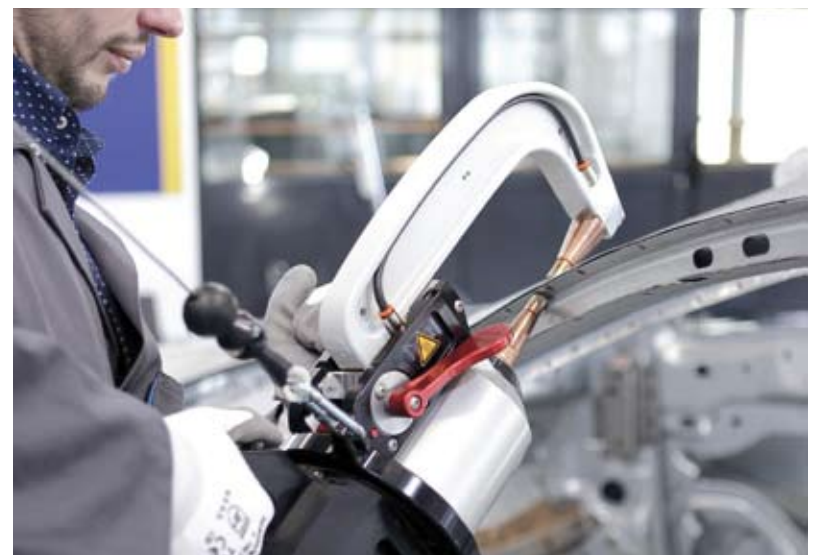
Zgrzewanie wymaga zastosowania prądów sięgających niemal 16 000 A przy jednoczesnym docisku elektrod wynoszącym do 350 daN (fot. GYS.pl)
