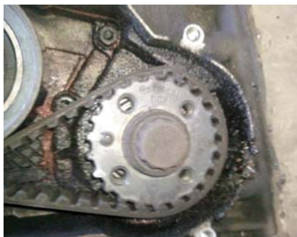
Fot. 3. Następstwem zerwania paska wielorowkowego w Volkswagenie Golfie było zniszczenie osłony paska rozrządu. Fragmenty osłony dostały się bezpośrednio pod pasek rozrządu, powodując jego przeskoczenie i unieruchomienie silnika
