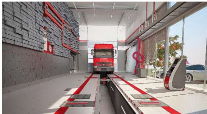
Rys. 2. Kanałowe stanowisko kontrolne stacji okręgowej z urządzeniami pomiarowymi linii uniwersalnej rozmieszczonymi na obrzeżach kanału przeglądowego (źródło: WSOP)
