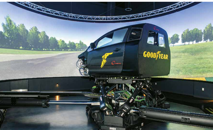
Symulator jazdy DiM250 DYNAMIC firmy VI-grade z Centrum Innowacji Goodyear w Colmar-Berg w Luksemburgu
