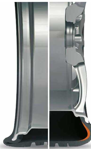
Przekrój opony konwencjonalnej vs opona typu run flat. Wzmocnienia ściany bocznej sprawiają, że po utracie powietrza można kontynuować jazdę. Byle naszym najbliższym celem był wulkanizator
