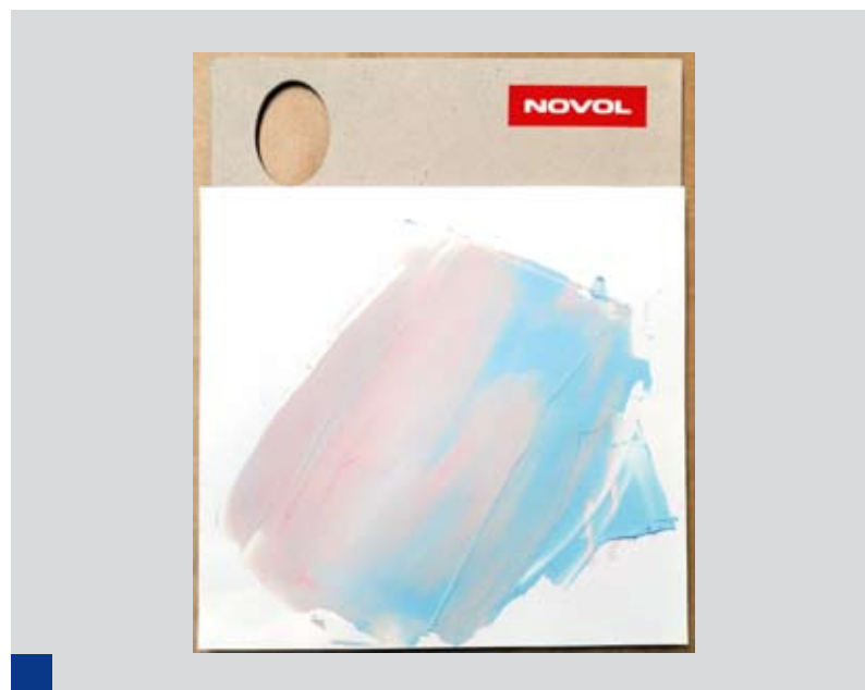
Rys. 4. Nieprawidłowe wymieszanie szpachłówki z inicjatorem w układzie ze wskaźnikiem mieszania (źródło: NOVOL)
