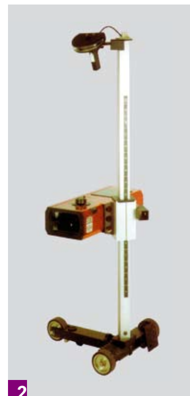
Przyrząd optyczny USP-20PS do kontroli świateł (źródło: Fudim-Polmo)
