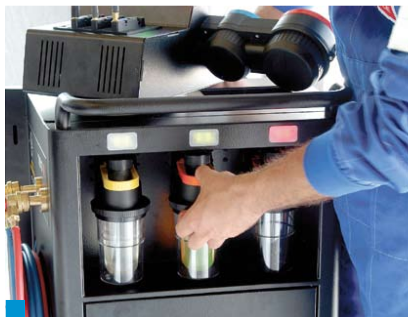
Hermetyczne, identyfikowalne zbiorniczki na olej i UV – Stacja Texa Komfort 760R
