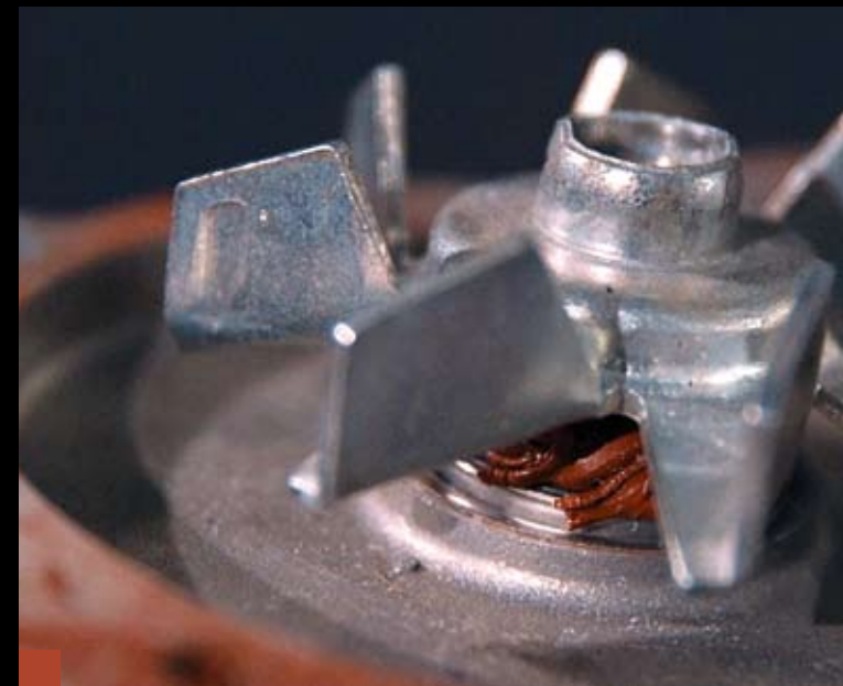
Odrobina silikonu pomiędzy pierścieniami uszczelniającymi = gwarantowany wyciek
