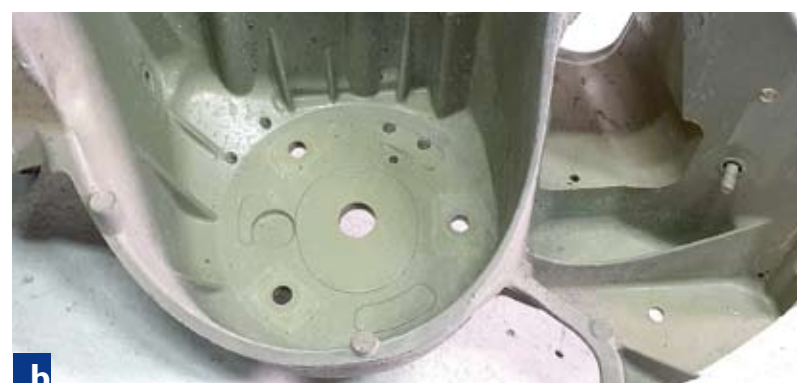
Z lewej strony przekrój elementu nośnego karoserii, po prawej fragment karoserii wykonany jako odlew ciśnieniowy (fot. BR)
