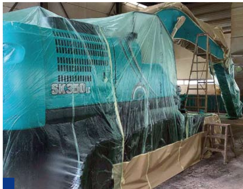
Poprawki lakiernicze po transporcie morskim to „oczko w głowie” szanujących się producentów maszyn
