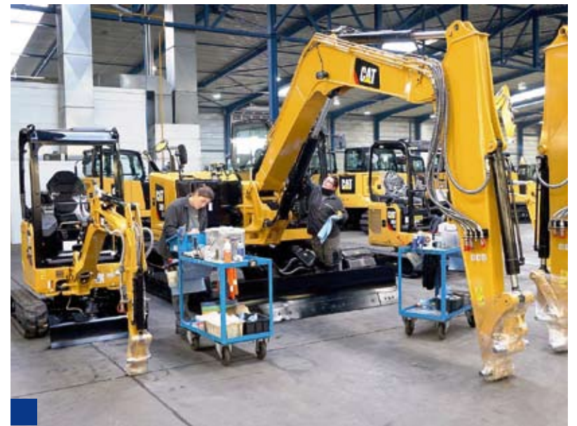
Nawet jeśli klient wybiera kolor podstawowy, poprawki lakiernicze są konieczne. Często oznacza to także naniesienie naklejek technicznych w narodowym języku użytkownika lub wymaganych przez lokalne prawo
