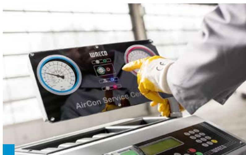
Wilgoć w układzie jest szczególnie niebezpieczna przy nowym czynniku, R 1234yf
