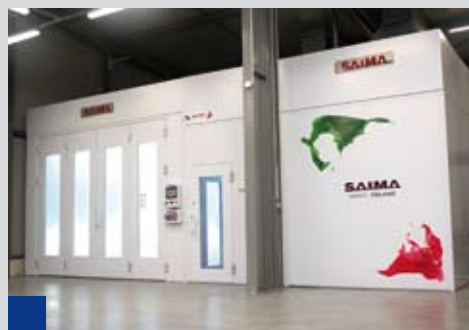
Zblokowana zabudowa kabiny i mieszalni
