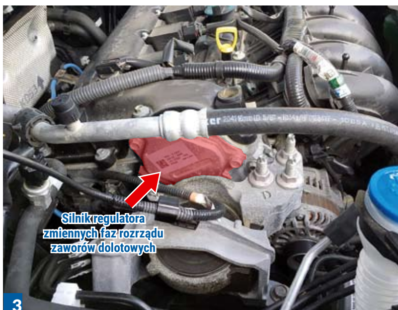
3 Sporych rozmiarów silnik regulatora zmiennych faz rozrządu zaworów dolotowych to cecha charakterystyczna dwulitrowego silnika pojazdu marki Mazda z technologią Skyactiv-G
