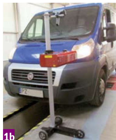
Rodzaje bazowania przyrządu USP-20 względem nadwozia (źródło: Fudim-Polmo): za pomocą wizjera/lustra (z lewej), projektorem świetlnym (w środku) i projektorem laserowym (z prawej)
