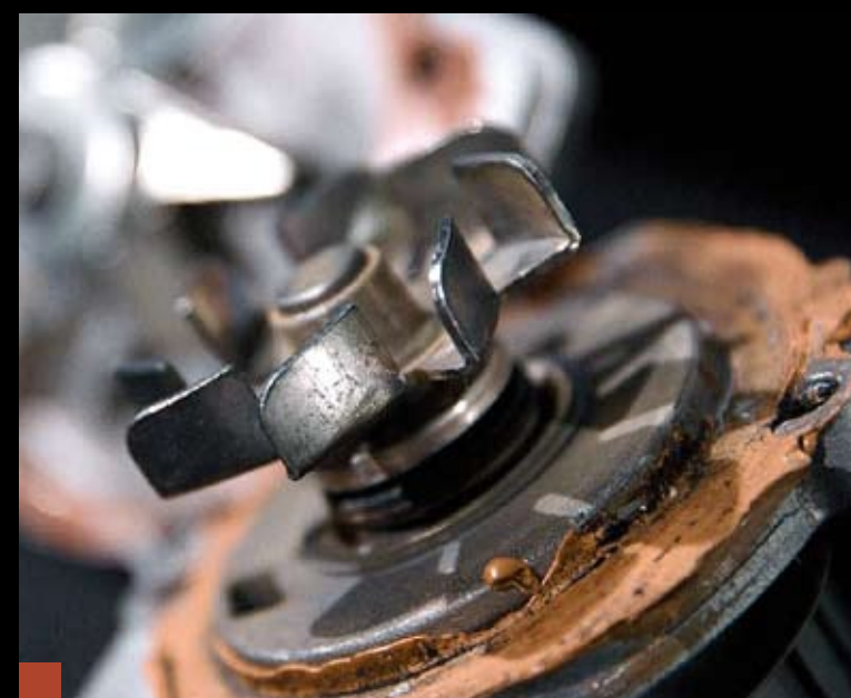
Pompa wody montowana „na silikon”
