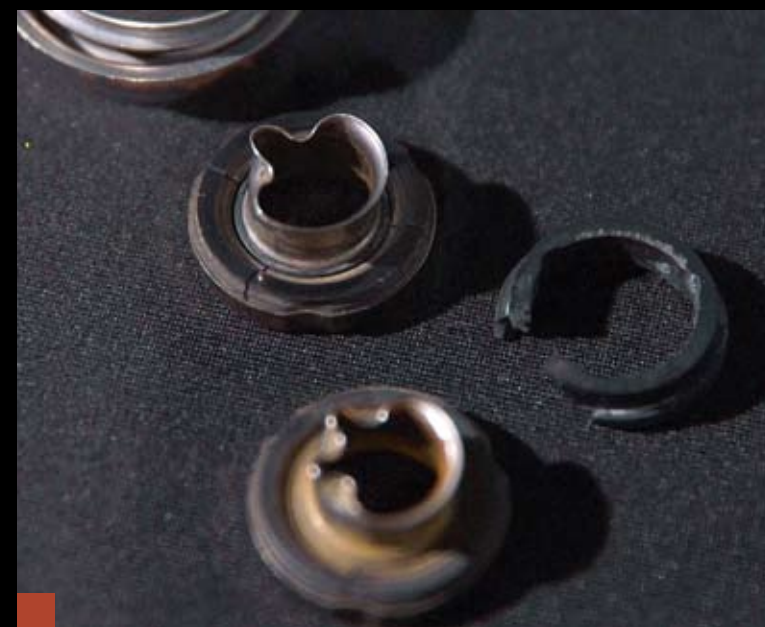
Uszkodzenia uszczelniaacza pompy cieczy
