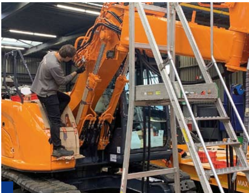
Lakierowanie maszyn wymaga także wiedzy z zakresu hydrauliki siłowej – przewody muszą być właściwie podłączone przed wydaniem klientowi
