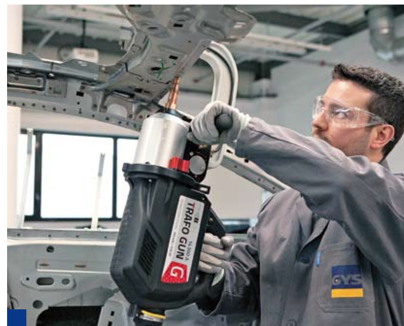
Zgrzewanie karoserii urządzeniem o bardzo wysokich parametrach z automatycznym doborem parametrów pracy (fot. GYS.pl)
