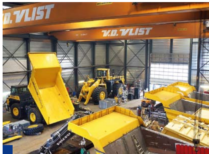
Duże maszyny przyjeżdżają w częściach. Na zdjęciu widoczne świeżo zespane koleby, które trzeba odpowiednio polakierować
