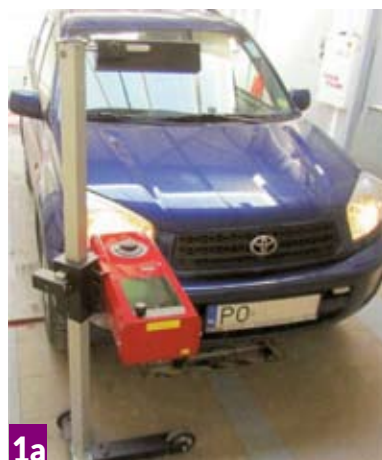
Rodzaje bazowania przyrządu USP-20 względem nadwozia (źródło: Fudim-Polmo): za pomocą wizjera/lustra (z lewej), projektorem świetlnym (w środku) i projektorem laserowym (z prawej)
