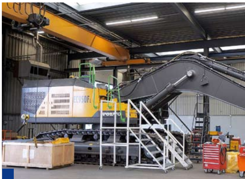
Przygotowanie maszyny do lakierowania wymaga często częściowego demontażu. Do tego potrzeba sporo sprzętu i doświadczenia, aby proces obył się bez utraty gwarancji
