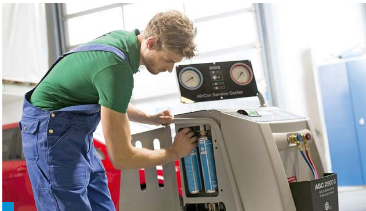
Waeco posiada w swoich urządzeniach hermetyczne pojemniki na olej PAG, które uniemożliwiają dostanie się wilgoci do układu klimatyzacji
