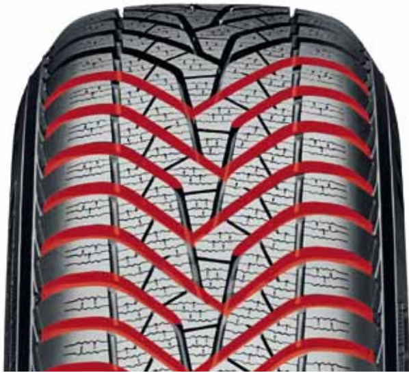
■ Opona zimowa Yokohama W.drive V905 z technologią See-Through. Układ rowków biegnących przez całą szerokość opony chroni przed aquaplaningiem
