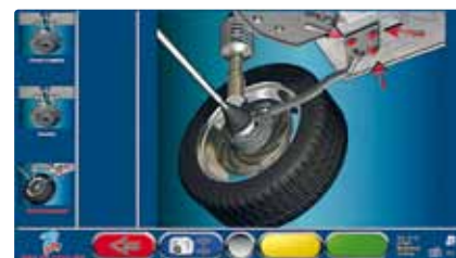
Wizualizacja punktów regulacyjnych i sposobu regulacji geometrii zawieszenia, dostępne tylko w oprogramowaniu modelu TD1780WS (animacje 3D)
