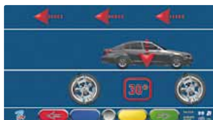
Wizualizacja kompensacji bicia obręczy przez przetaczanie pojazdu
