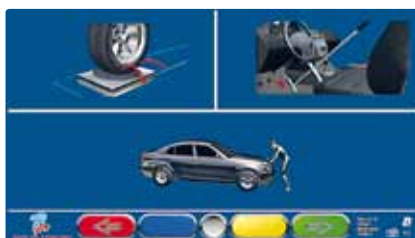
Ustawienie kąt na obrotnicach, blokada kierownicy i pedału hamulca, odprężenie zawieszenia
