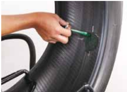
Fot. 2. Kotek „grzybek” w łatwy sposób umożliwia wypłnienie kanatu uszkodzenia
