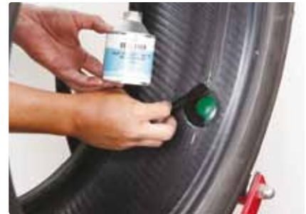
Fot. 4. Sealiner nakładamy wokół materiału naprawczego
