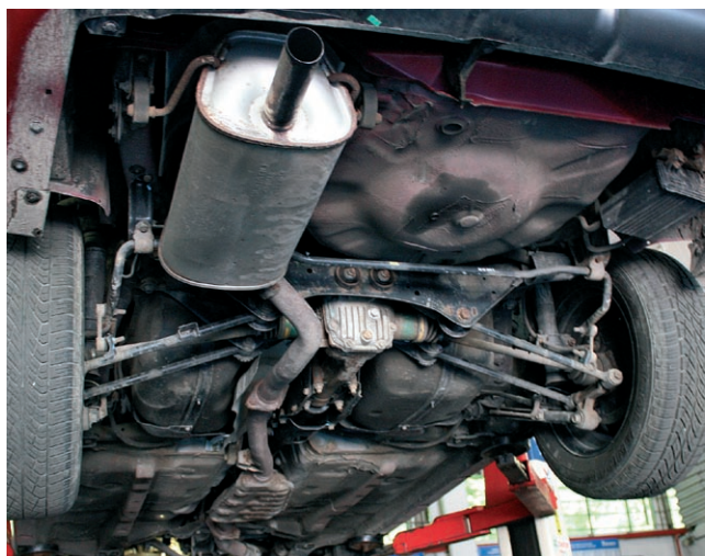
Pierwszym krokiem przy diagnozowaniu usterek powinna być wzrokowa kontrola poszczególnych elementów składowych zawieszenia
