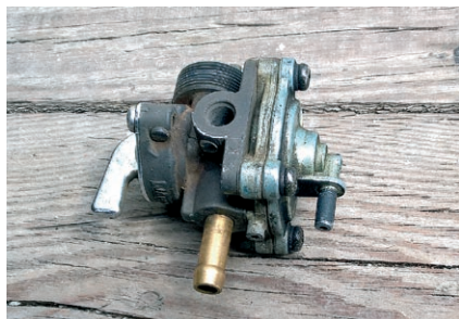
Ręczny kranik podciśnieniowy. Widoczny układ sterowania podciśnieniem wraz z króćcem łączącym kranik z kolektorem dolotowym
