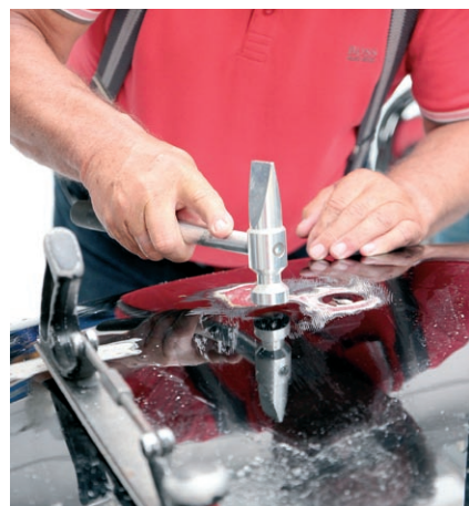
Doprowadzając uszkodzenie do fabrycznej wypukłości, warto wyrobić sobie nawyk „dociskania” palcem rękawicy młotką, gdy tylko obuch uderzy w powierzchnię naprawianego elementu
