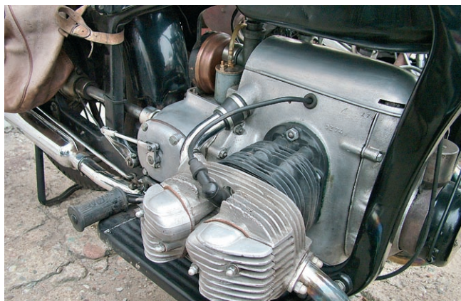
Powierzchnia bloku silnika i zebra głowicy zabytkowego motocykla Zundapp, z widocznymi śladami utlenienia spowodowanego złymi warunkami atmosferycznymi
