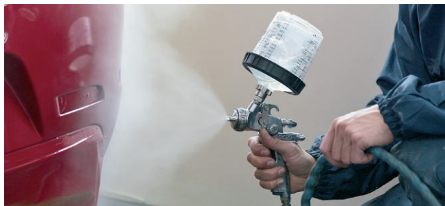
Grubość powłoki lakieru bezbarwnego w dużym stopniu decyduje o tym, jak odbierany jest kolor warstwy bazowej
