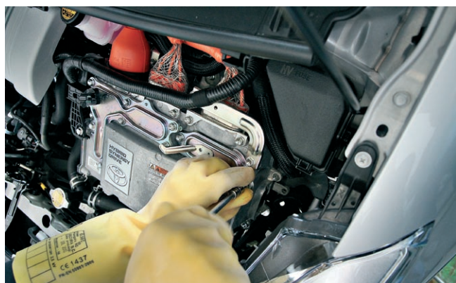
Obsługa samochodów HV (hybrydowych i elektrycznych) może być przeprowadzana jedynie przez osoby posiadające odpowiednie przeszkolenie i uprawnienia (SEP 1 kV)
