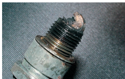
Świeca z elektrodami pokrytymi grubą warstwą nagaru. Świadczy to o zużyciu silnika lub stosowaniu niskiej jakości oleju i paliwa
