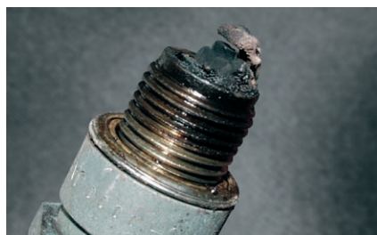
Świeca z elektrodami pokrytymi grubą warstwą nagaru. Świadczy to o zużyciu silnika lub stosowaniu niskiej jakości oleju i paliwa
