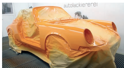
Duża liczba plam rdzy oznaczała, że prawie 50-letnie Porsche 911E Targa wymaga kompletnej renowacji i nowego lakieru
