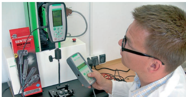
Stanowisko do pomiaru siły wrywania końcówek – tu weryfikowana jest jakość połączenia końcówek z kablem
