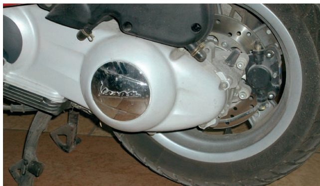
Obudowa przekładni bezstopniowej w skuterze Vespa o pojemności 250 cm 3
