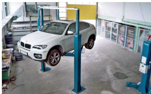
2-kolumnowe okazują się przede wszystkim relatywnie tanie, stąd ich popularność. Gdy podnośniki są schowane w podłogę, żadna kolumna nie blokuje ruchu
