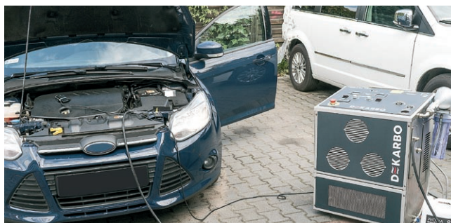
Zakres dekarbonizacji jest niemały, skoro obejmuje: wtryskiwacze, świece zapłonowe, zawory, turbosprężarki, filtr FAP/DPF, głowice, katalizator...
