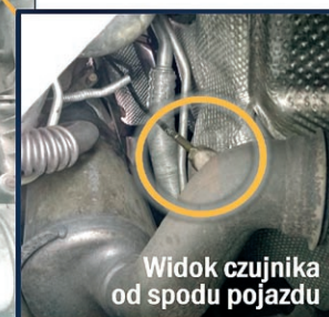
Widok komory silnika – przybliżona lokalizacja czujnika temperatury spalin i jego wtyczki
