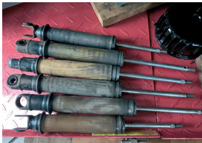
Amortyzatory motocyklowe pozbawione szklanek, sprężyn i wstępnie umyte, oczekujące na regenerację
