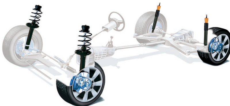
Technologia wykorzystująca wewnętrzną sprężynę ruchu odbicia stosowana była już pod koniec lat 90. Ostatnie lata to niemająca precedensu ewolucja piasty zintegrowanej
