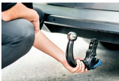
Wszelkie uszkodzenia mechaniczne zaczepu kulowego wykluczają jego dalszą eksploatację
