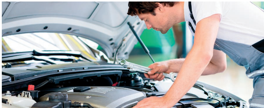
Piszczenie spod maski zgłaszane jest zazwyczaj podczas rozruchu. Jego przyczyną jest bardzo często pasek wielorokowy osprzętu
