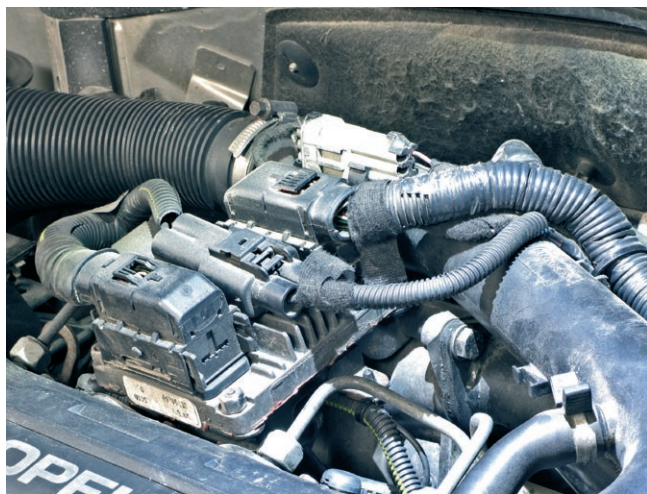
Dostanie się do uszkodzonego przewodu CAN wymaga często rozprucia okablowania
