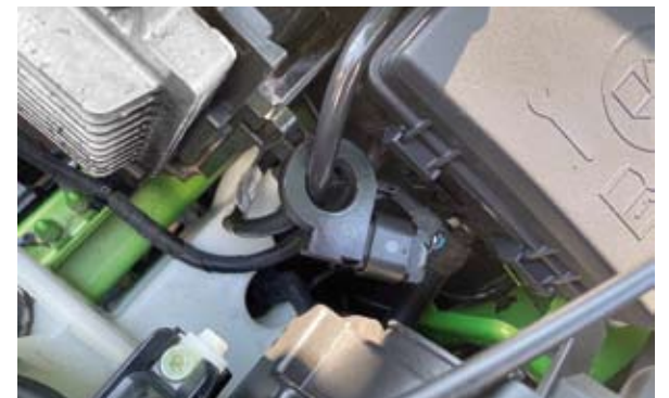
Fot. 4. Sterownik zarządzający energią elektryczną wraz ze sterownikiem silnika na podstawie czujnika poboru prądu akumulatora precyzyjnie określają wydajność alternatora i sterują jego działaniem podczas pracy silnika. Na zdjęciu czujnik prądu akumulatora monitorujący przepływ natężenia na przewodzie terminala nr 30
