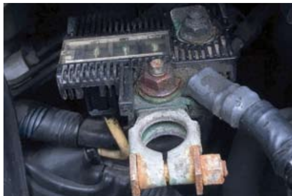
Fot. 1. Korozja i utlenianie powierzchni styków dodatniej klemy akumulatora jest zwykle przyczyną spadku napięcia pomiędzy zaciskiem B+ alternatora a dodatnim biegunem akumulatora
