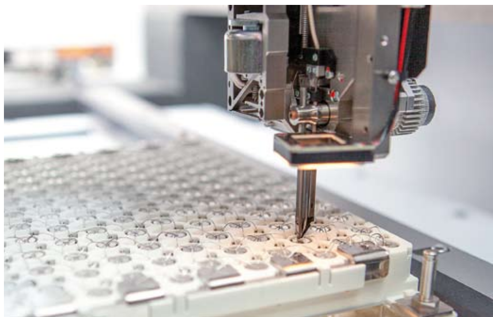
Proces zgrzewania ogniw litowych w technologii Wire Bonding w firmie Wamtechnik
