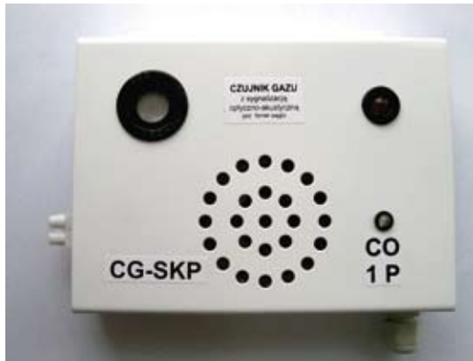
Rys. 3. Alarmowy czujnik nadmiernego stężenia tlenu węgla (CO) typu CG-SKP 1P (źródło: Sosnowski)
