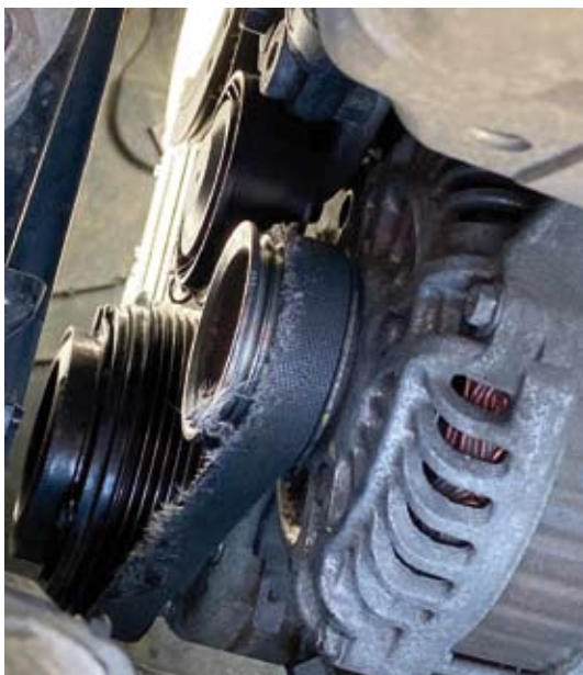
Fot. 2. Uszkodzenie paska wielorolkowego napędu alternatora generuje wyraźnie słyszalne hałasy
